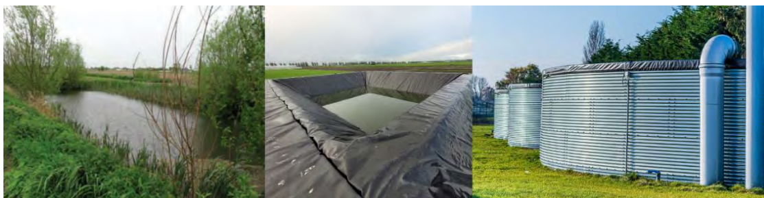
Figuur 73: vlnr: 1) Open bufferbekken. Bron: Aquafin. 2) Foliebassin. Bron: Inagro. 3) Watersilo. Bron: Waterportaal.
