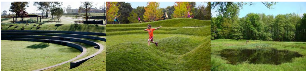
Figuur 41. Voorbeelden van bovenlokale buffers. Bovenlokale buffers kunnen meerdere functies combineren. Links en midden wordt de bufferfunctie gecombineerd met een recreatieve functie, waar de foto rechts infiltratie en buffering combineert in een wadi.
