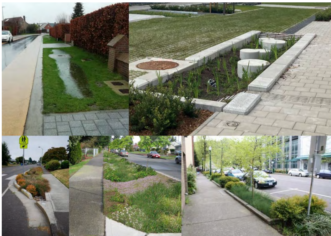
Figuur 35. Vlnr en vbno: (1) Infiltratiekom langs de straat. © Kruisem; (2) Bufferend plantvak (Aziëlaan Wilrijk, tuinstraat). © Aquafin; (4, 5 en 6) Mogelijke vertragingsmaatregelen waarbij de inplanting zoveel mogelijk wordt uitgespreid en focust op water vasthouden. © Aquafin.
