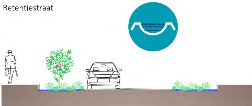
Figuur 23: Schematische voorstelling van een retentiestraat. © Aquafin
